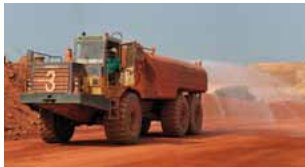
Guiné Caminhão-pipa usado para controle de poeira gerada por nossas atividades em Siguiri.
