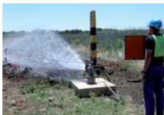
Prueba de bomba en un nuevo pozo de sondeo en el área del Río Vaal para determinar el volumen de agua que puede bombearse diariamente
