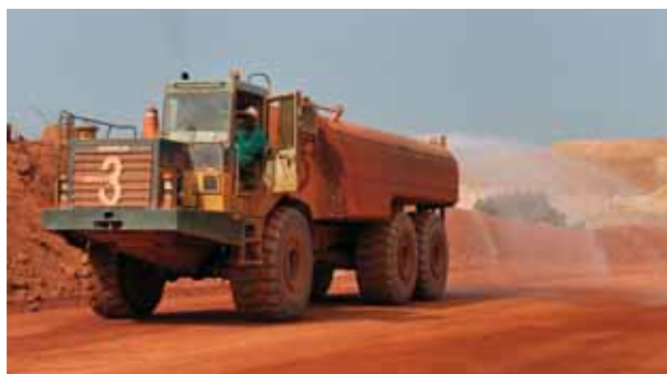
Guinea Camión cisterna en uso en Sigiuri para suprimir el polvo en las carreteras
